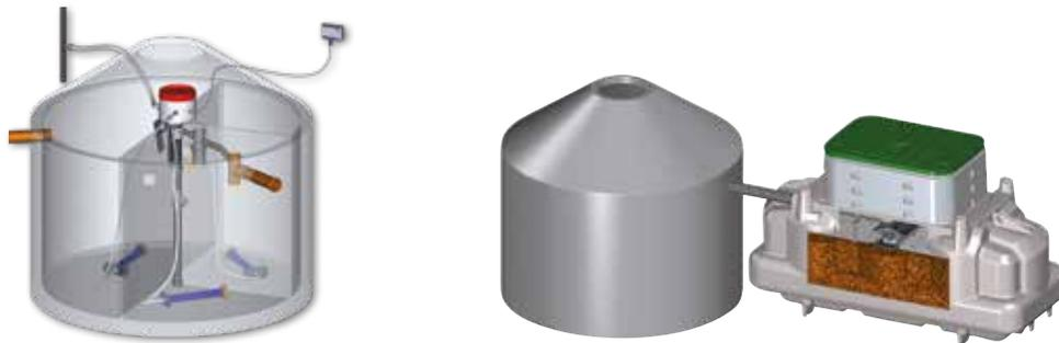
... als technische SBR-Anlage oder **naturnah und stromlos**
